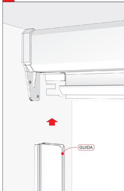
**5** Fissare le guide al vano, con le apposite viti.
